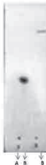
شکل ۲. TLC برای نمونه قبل از تخریب شدن و بعد از تخریب شدن (Rf A رنگزای اصلی: ۰/۰۴، Rf B رنگزای بی رنگ شده: ۰/۵۱، ۰/۶۰)
